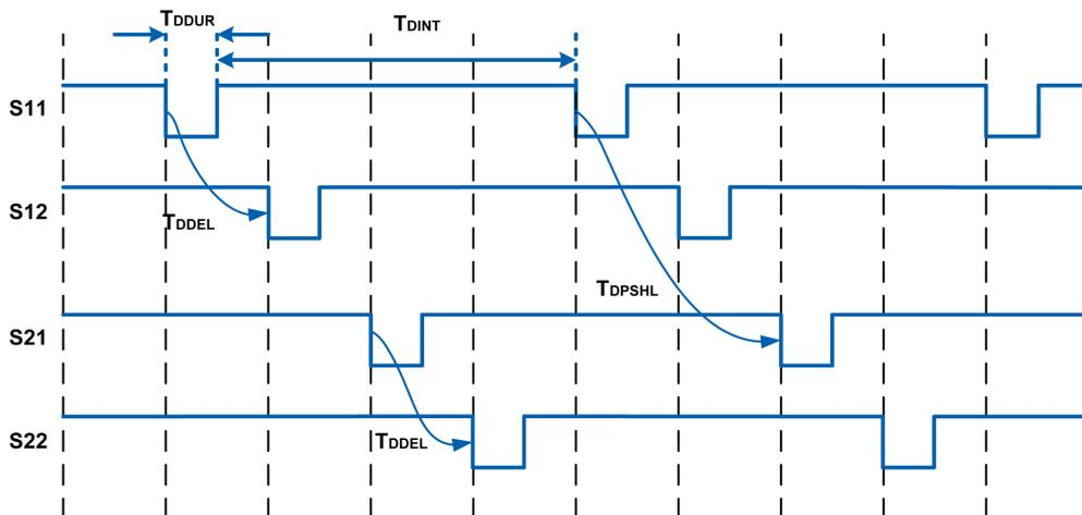
この図は、入力チャンネル S11-S12 および S21-S22 を示しています。残りの入力チャンネル S13 と S23 の場合でも同様となります。
