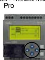
正面操作钮的输入可作为外部输入实用。方便即使没有周边设备也可进行程序确认或变更。
