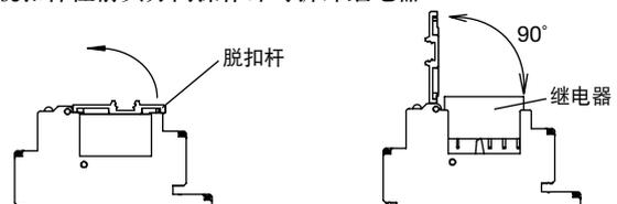
注 2：拆卸继电器时，请注意继电器会突然被弹出而导致破损或丢失。请务必用手指等轻轻按住继电器再操作脱扣杆。
