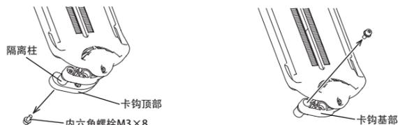
(1) 取下卡钩表面的内六角螺栓。(六角扳手尺寸：2.5)
